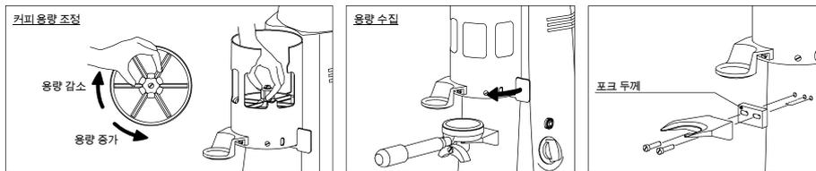
커피가 필터 홀더에 떨어지게 하려면, 두 개의 구멍을 이용하여 서포트 포크를 옆쪽으로 이동하고 최적의 위치를 찾습니다. 필요하다면, (패키지에 포함된) 심을 사용하여 포크의 위치를 되돌립니다. 최적의 위치를 찾은 후, 해당 나사를 사용하여 포크를 고정합니다.
